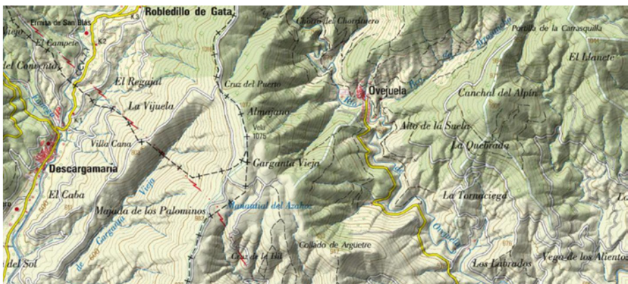
Figura 30. En este caso se observa el diferente trazado de la red fluvial hurdana, río Ovejuela, de meandros encajados (índice de sinuosidad ( I_s ) de 1,72), respecto de la rectilinearidad del Arrago en Descargamaría ( I_s = 1,21 ) y su afluente el Arroyo de Garganta Vieja ( I_s = 1,05 ). Los valores están tomados en la imagen superior.
