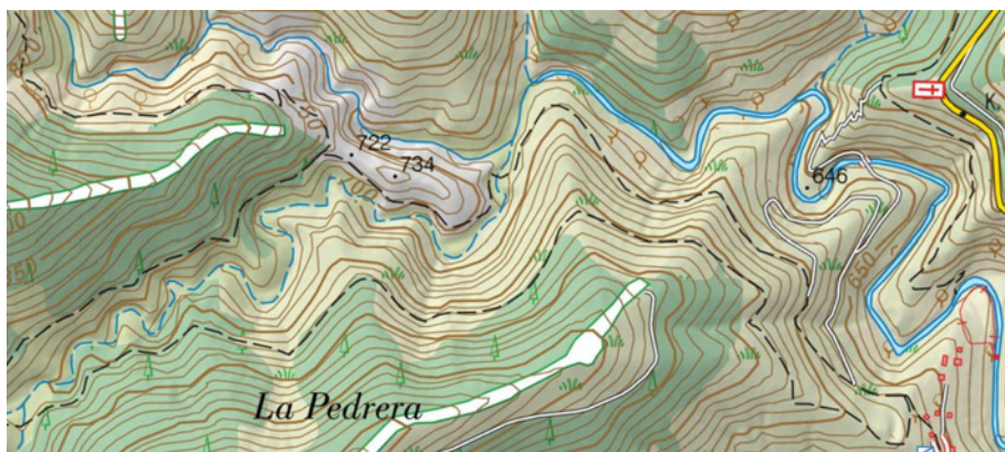
Figura 31. Lejos de lo cabría esperar en unos terrenos esquistosos tan antiguos, donde deberían predominar las fallas y las líneas de esquistosidad, a esta escala el trazado de los ríos es sinuoso, independiente de las lineaciones.
