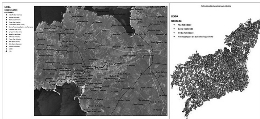
Figura 11. Izquierda: visor con información toponímica de distintos mapas digitales (Catastro, PGOM, Mapa 1:5.000, mapa 1:25.000...). Derecha: control de calidad de las coordenadas de los topónimos del NG 2003 en la provincia de A Coruña. Los no localizados (puntos rojos) se han situado al lado de la iglesia parroquial a la que pertenecen según están clasificados en el NG 2003.
