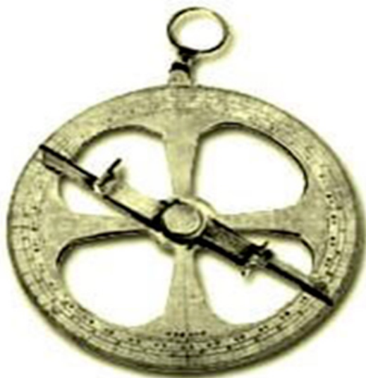
Figura 15. Astrolabio náutico. Máxima simplificación del astrolabio universal. Sólo se conserva la alidada de pínulas para medir la altura de los astros.
