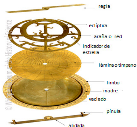
Figura 6. Partes del Astrolabio.
