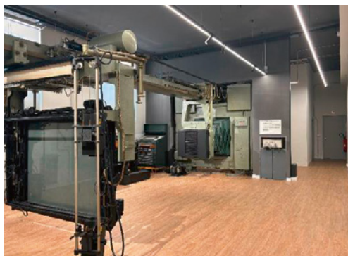
Figura 9. Cámara de reproducción cartográfica modelo Klimsch Commodore (2024, sala-museo de artes gráficas del IGN).
