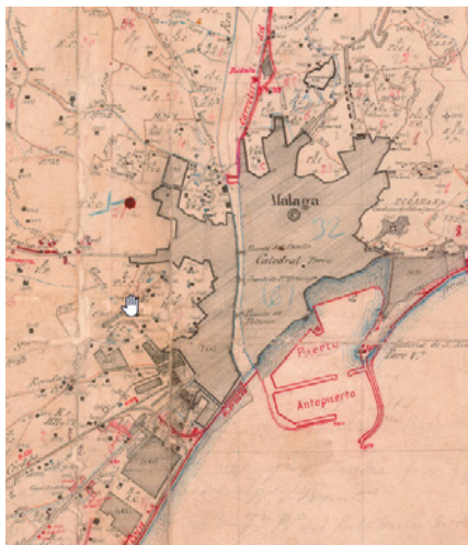
Figura 4. El límite del casco urbano de Málaga en la Planimetría de 1873-1874. En rojo figuran las obras de ampliación del puerto, proyectadas por el ingeniero Rafael Yagüe Buil en 1876 y ultimadas en 1897.
