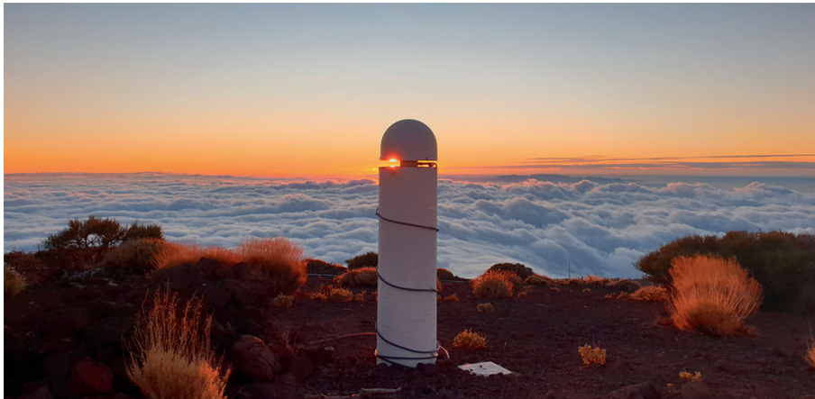
Estación permanente de la red ERGNSS (Red Geodésica Nacional)
