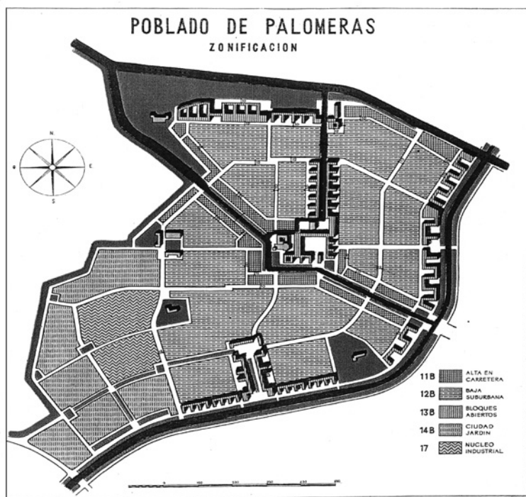
Figura 14. Plano de la segunda versión del poblado de Palomeras dentro del Plan de Núcleos Satélites de Madrid, 1954. Zonificación de usos y tipologías edificatorias Detallando la ubicación de los centros de servicios y de la edificación en altura. Fuente: Gran Madrid , n.º 24, 1954, pp. 11-12.
