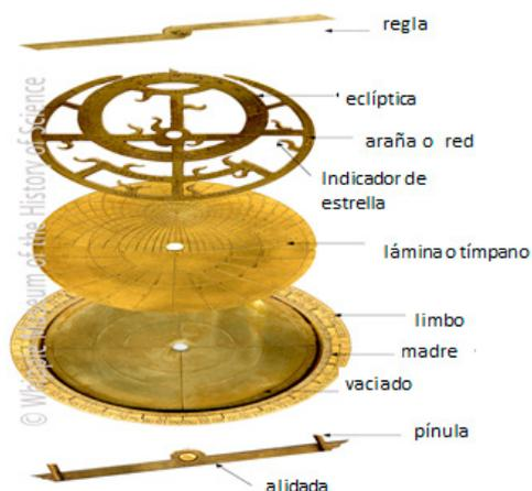
**Figura 6.** Partes del Astrolabio.
