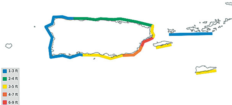
Figura 2. Inundación por marejada ciclónica estimada (pies sobre el nivel del suelo). Observaciones del nivel del agua a lo largo de las costas de Puerto Rico y las Islas Vírgenes de los Estados Unidos. Imagen cortesía de la Unidad de Marejada Tormenta del NHC. Fuente: National Hurricane Center Tropical Cyclone Report. Hurricane Maria (AL152017) 16-30 september 2017.
